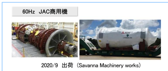
図 13 M501JAC 形ガスタービン商用機の出荷の様子(60Hz)
