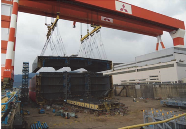
図1 ゴライアスクレーンでの搭載状況 (オイルタンカー約 1500トン (60m×45m)ブロック)
