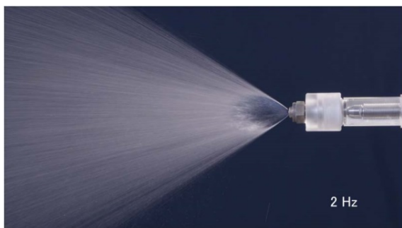
図9 連続鋳造機用二次冷却ノズル
