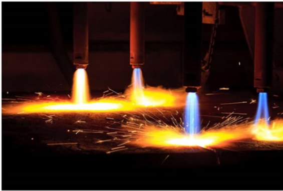
図7 連続鋳造機のトーチカッターノズル
