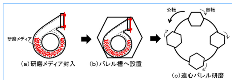
図11 研磨メディア封入方式の遠心バレル研磨
