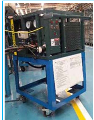
図4 代替フロン回収装置
