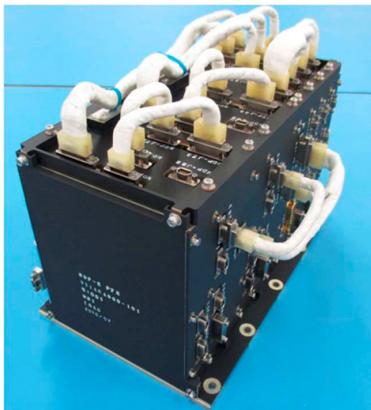
図3 “あらせ” ミッション・データ・プロセッサ/ データ・レコーダ (MDP-E)
