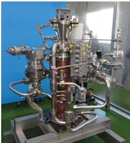
図 12 技術実証エンジン飛行用改修状況
