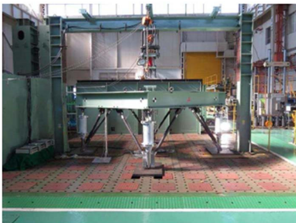
図6 着陸脚システムによる衝撃吸収性能確認試験
