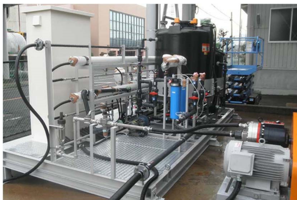
図7 4インチ RO 膜ユニット外観写真
