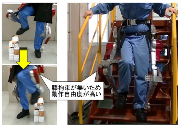
図7 跨ぎ試験(左), 階段昇降試験(右)
