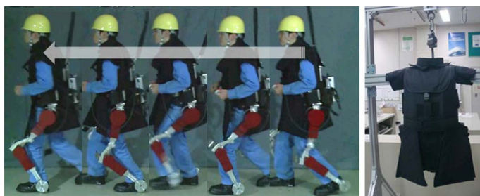
図5 遮へいジャケット(右)と歩行試験の様子
