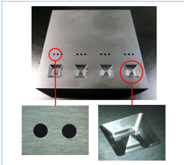
図1 超硬穴あけ及び形状加工ワーク
