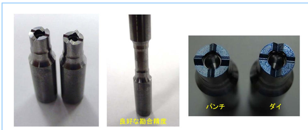
図2 超硬パンチ及びダイ加工ワーク
