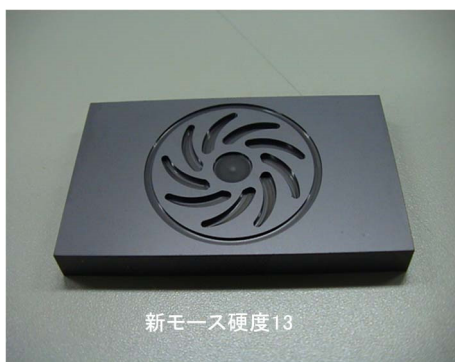
図3 SiC セラミック溝加工ワーク
