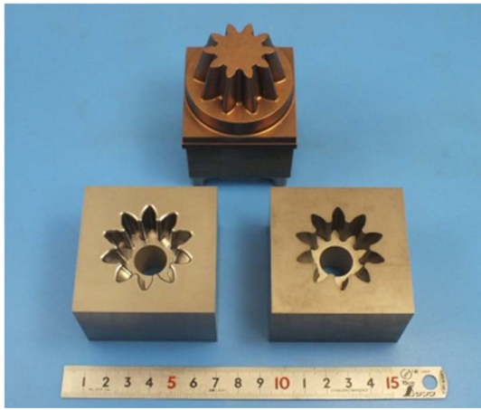
図5 銅グラファイト電極ワーク(上) 及び ベベルギヤ金型(左下:仕上げ後、右下:仕上げ前)
