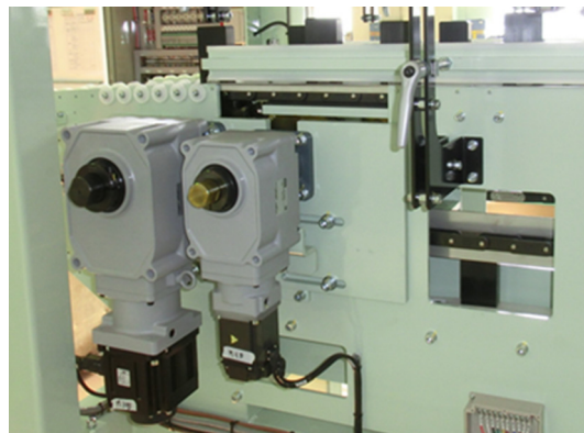
図3 包装設備駆動部 マルチサーボ駆動機構採用(新型)
