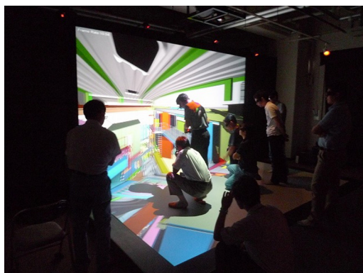
図4 風車ナセル内の組立・施工方法検討
