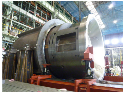
図9 バンドル引き抜き工場試験
