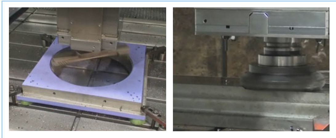
図3 φ600 ボーリング, φ200 フライスでの高能率荒加工例
