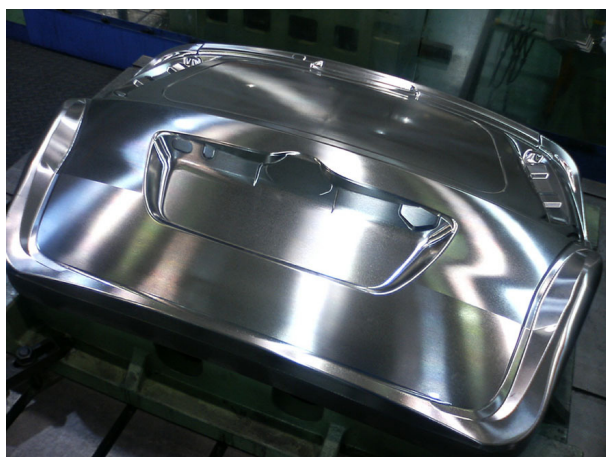
図4 φ30 ボールエンドミルでの高精度仕上加工例
