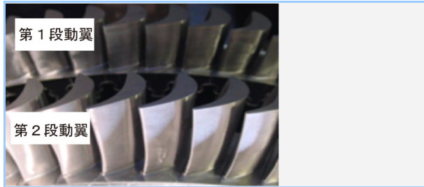
図5 高速回転翼列試験のロータ (第1段動翼及び第2段動翼)
