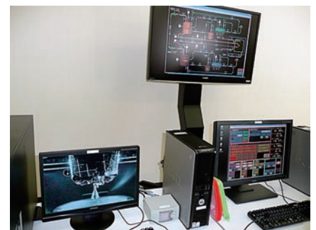
図6 計測・制御システム 燃焼試験設備で使用している計測・制御システムの外観を示す。
