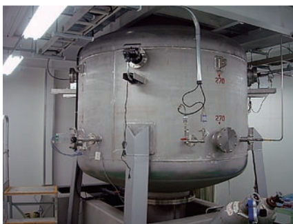
図4 真空チャンバ 燃焼試験設備で使用している真空チャンバの外観を示す。
