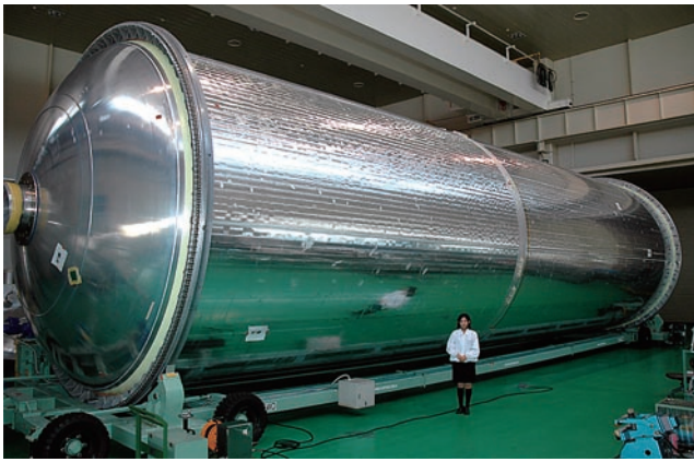
図4 試験機用液体水素タンク(直径 5.2m, 長さ 19.4m)
