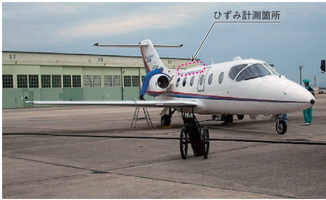
図4 飛行実証試験供試機 (MU-300)
