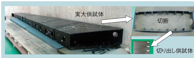
図8 実大供試体切断 強度試験後の実大供試体を切り出し、品質確認を実施した。
