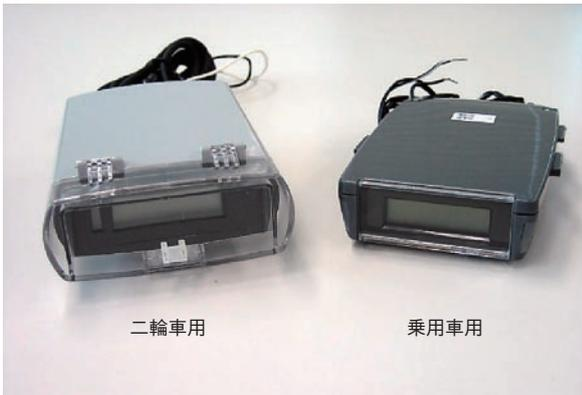
図2 シンガポール向け ERP 用次期型車載器
