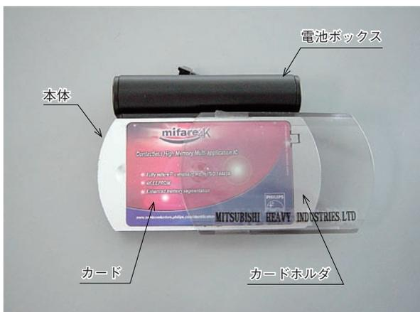
図3 IURP 用 DSRC 車載器 (試作モデル)
