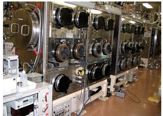
図3 直接抽出試験装置外観 (7) JNC(当時)／CPFグローブボックス内に設置した試験装置。
