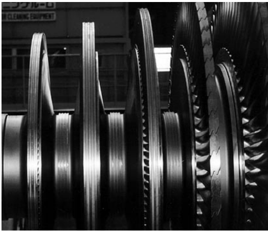
図5 インテグラルシュラウドブレード (ISB) 適用状況
