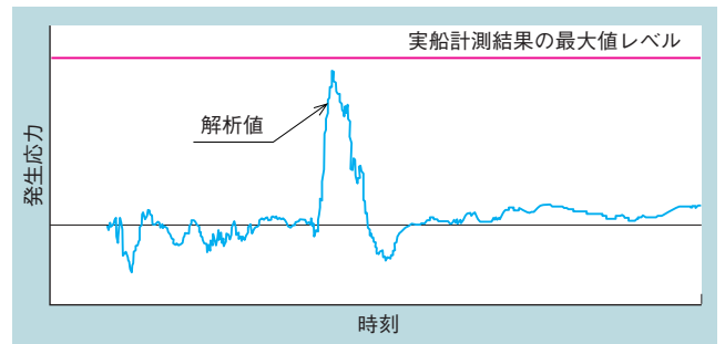
図7 実船計測応答量と時刻歴解析結果の比較 解析は実船で計測された応力値を再現できている。
