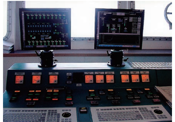
図3 ドレッジコントロールモニタリングシステム (DCMS)
