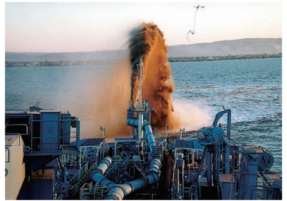
図2 バウノズルディスチャージ（レインボー）による排出
