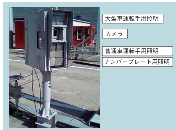
図3 新型撮像装置試作機 カメラの上下に照明を配置している装置を示す。
