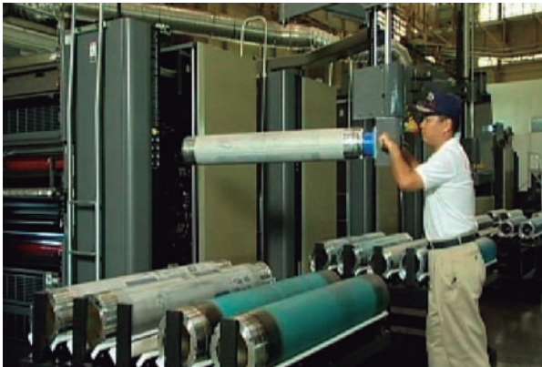
図2 スリーブ交換作業
