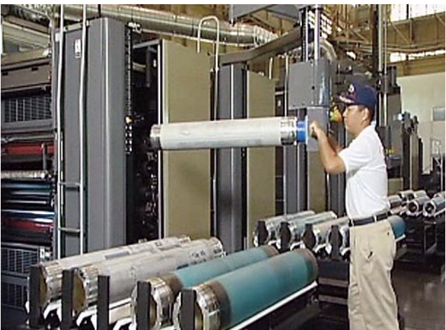
図2 スリーブ交換作業
