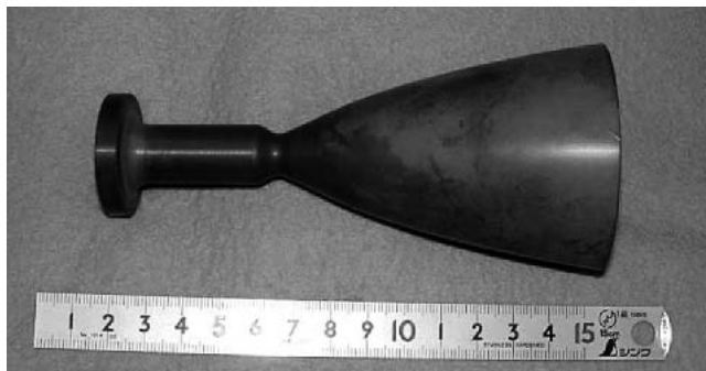
図5 20N二液スラスタ燃焼器 全長約130 mm, 最大径60 mm.
