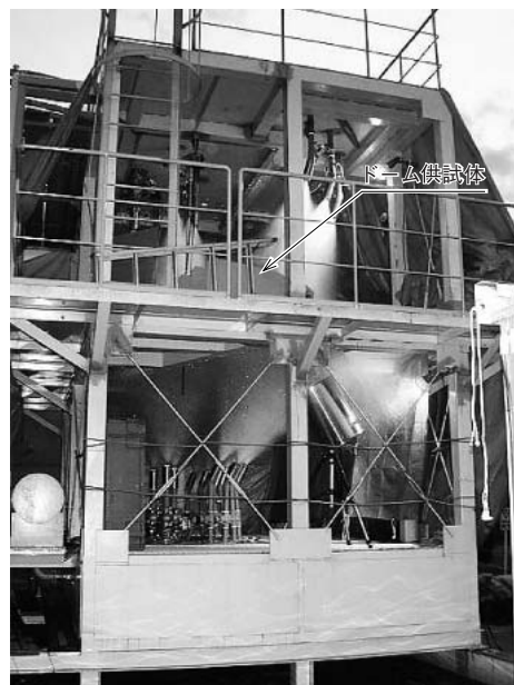
図9 ドーム焼入れ性能確認試験 実機ドームの1/4周を模擬した供試体により、スプレー焼入れ方式の焼入れ装置に関する冷却性能を確認した。
