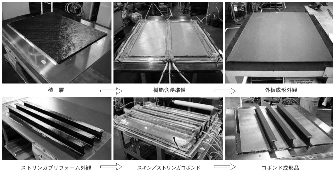
図5 3ストリングパネル成形工程
