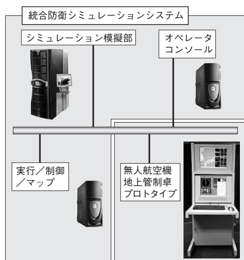
図2 地上管制卓プロトタイプと統合防衛シミュレーションとの接続
