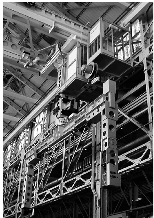
図3 特殊クレーン 製品の安全な回転が可能。
