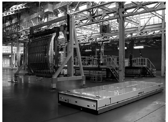
図2 自動搬送車 無人でのポジション移動が可能。
