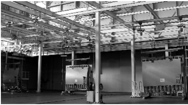
図4 モノレール 機構組み付けポジションと精度検査ポジション.
