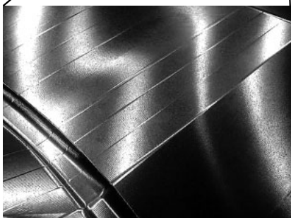
図4 アウター金型加工例 自動車外板部品の金型加工例で加工ピックの乱れの少ない高品位な加工面を示す。
