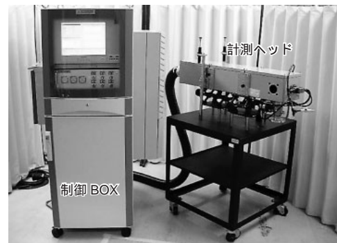
図1 レーザ誘起ブレイクダウン法試作装置 制御部と計測ヘッド部を分割し、実フィールドへの適用性を向上した。
