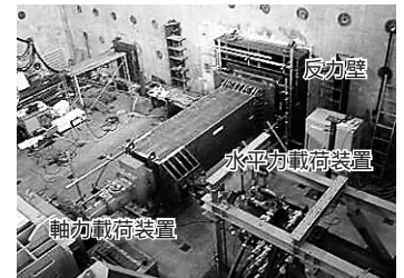
図8 強度性能の検証 試験状況．
