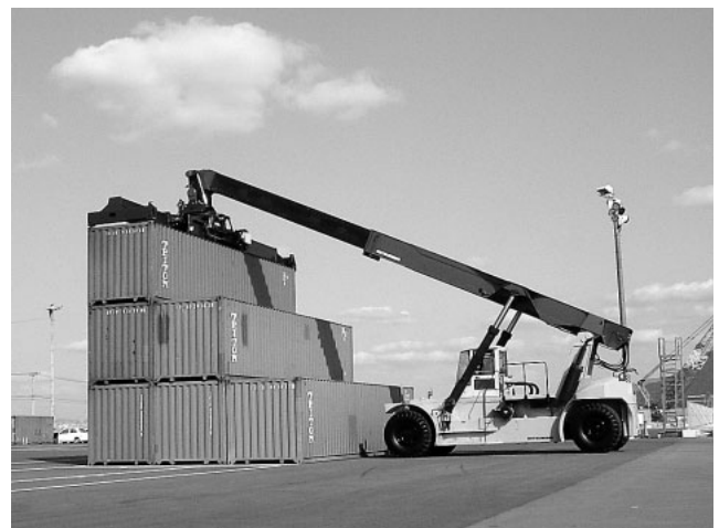
図2 リーチスタッカの作業風景
