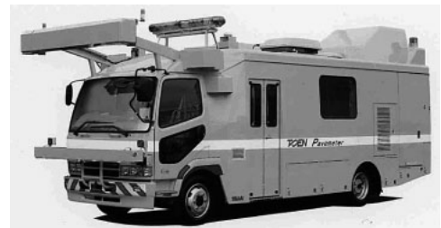
図5 路面性状測定車 各種測定装置を装備する路面性状測定車の外観を示す。
