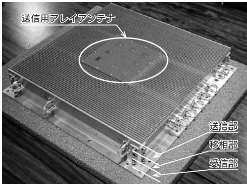
図4 アクティブ集積アンテナの構成 受信部, 移相部, 送信部の3層から構成され, マイクロ波の送信用アレイアンテナを有する.
