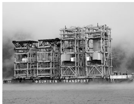
図5 ボイラモジュール輸送
