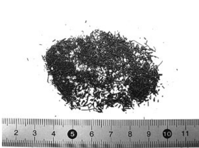
図5 回収砂中メッシュワイヤ 循環砂中から回収したメッシュワイヤは砂粒径程度に酸化・粉化している。
