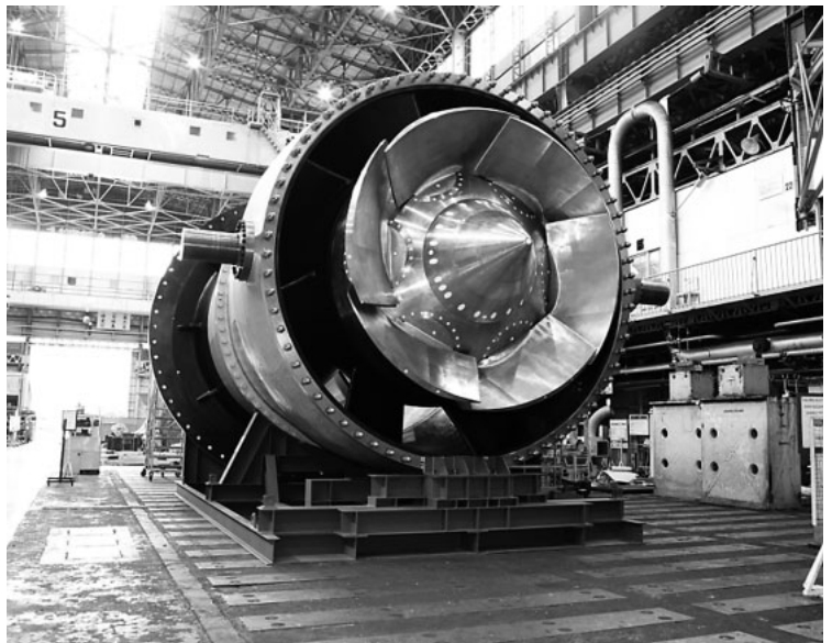
立軸斜流ポンプ，立軸軸流ポンプ （洪水対策，下水道，発電所循環水用）
