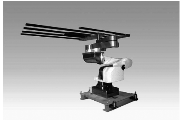
図8 液晶ガラス基板ロボット (大気中搬送用)
