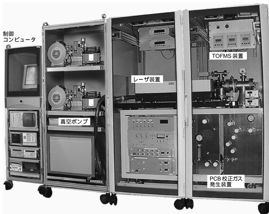
図2 ガス中PCB濃度計 (MOHMS-21GP) 装置写真 本装置はレーザー装置, TOFMS計測装置, 真空ポンプ, 制御コンピュータ及びPCB校正ガス発生装置により構成される。
