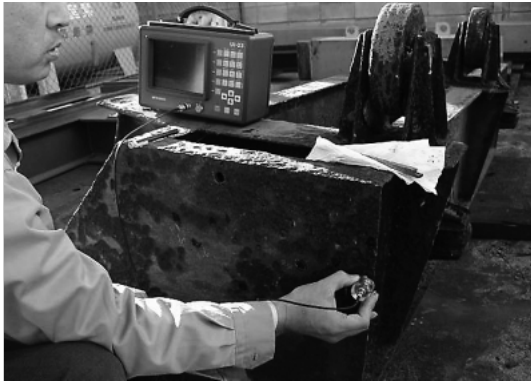
図4 水門扉の板厚測定状況 開発した装置を用いた、劣化した水門扉体の板厚測定状況。
