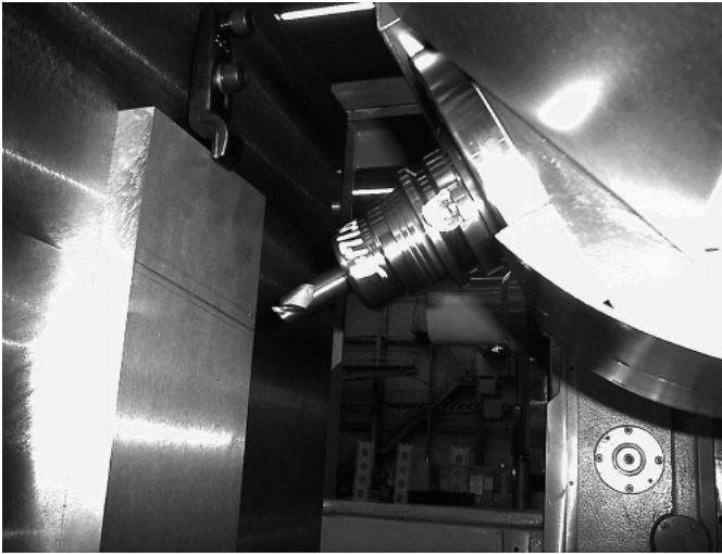
図5 ヘッド5軸加工機 5軸加工マシセンの一例として、ヘッドチルト形5軸加工マシセンの例を示す。
