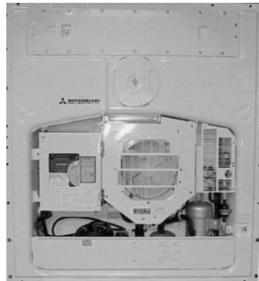
図13 海上レフユニット外観
