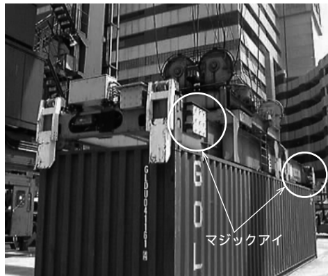
図10 マジックアイの図と写真
