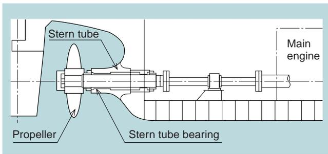
**Fig. 1 Shaft arrangement**
