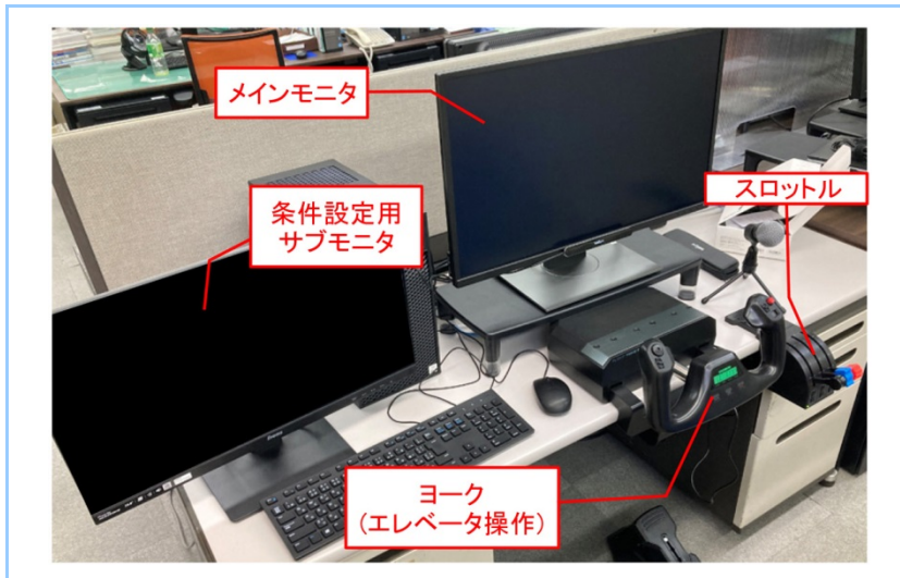
図6 熟練者データ収集に用いた機器の構成
