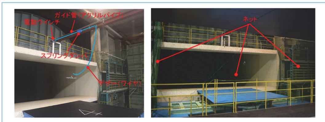
図2 安全装置(左:テザーシステム, 右:防球ネット)
